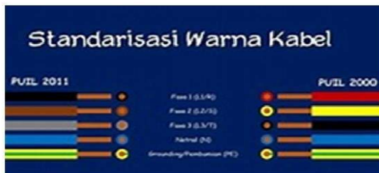
Gambar 4.15. Standard Warna Kabel Menurut POIL 2011 dan PUIL 2000
